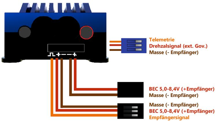
In der Regel werden die Signal- und BEC-Kabel im Heli von vorne nach hinten am Motor vorbei verlegt. Bitte beachten Sie dabei, dass die Empfänger-, Telemetrie- und BEC-Kabel gebündelt auf einer Seite entlang geführt werden müssen!
