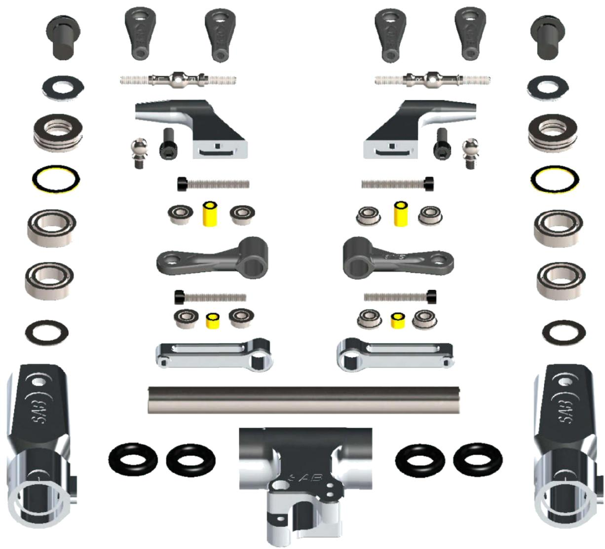
Y-Gelenk: Distanzhülse einsetzen, Flanschlager beidseitig einpressen
