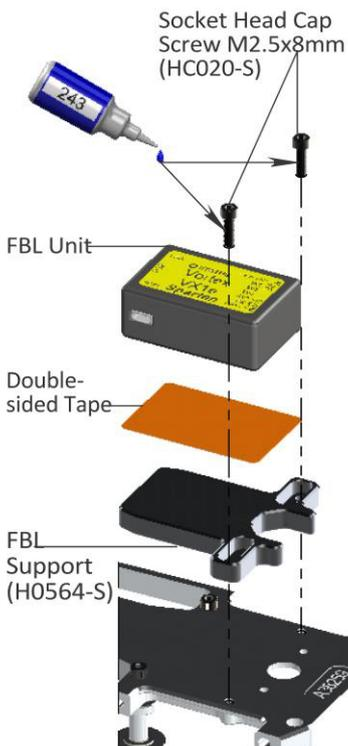
Fig. 2: zeigt ein FBL System direkt auf der Einbauebene H0564 montiert
