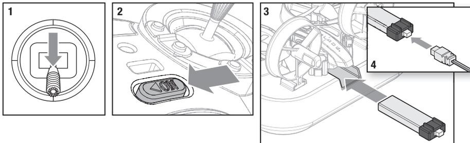
1. Stellen Sie die Gaszufuhr auf die niedrigste Einstellung ein. Bei BNF-Fluggeräten aktivieren Sie „Gas halten“, wenn Ihr Sender so ausgerüstet ist.
