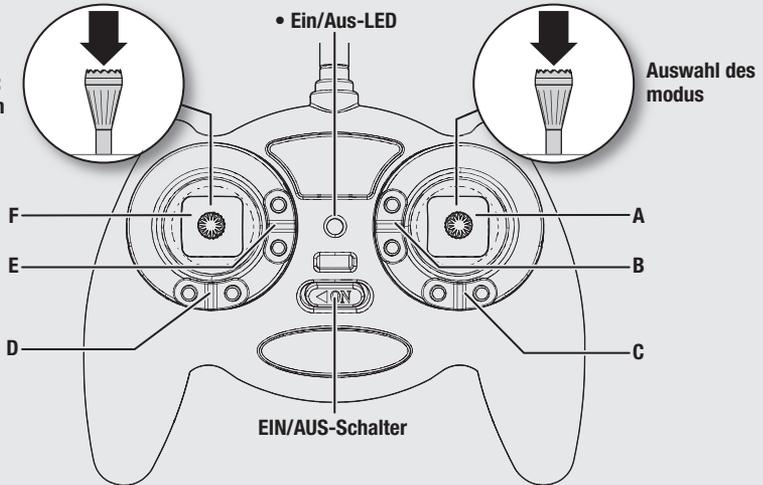
Wenn die Trimm Tasten gedrückt werden, geben sie einen Signalton von sich, der bei jedem erneuten Drücken höher oder tiefer wird. Die mittlere oder neutrale Trimmstellung erklingt in der mittleren Tonhöhe. An den äußeren Enden des Steuerbereichs erklingt eine Tonfolge.
