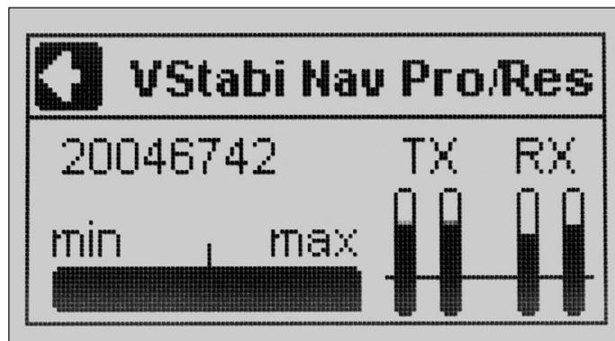
Sobald ein Empfänger verbunden ist, finden Sie im Menü **Info/Status Modell-Status** eine Anzeige zur Beurteilung der Empfangsleistung. Sie sehen Live-Balkenanzeigen für die Leistung der vier Antennen (Tx=Sender, Rx=Empfänger).
