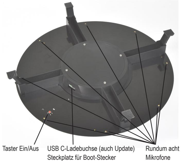
Die Landeplattform und das Modell kommunizieren über Ultraschall und 2,4 GHz Funk, Landeplattform, Modell und Sender kommunizieren über 2,4 GHz-Funk. In der Landeplattform ist ein über den USB C-Anschluss aufladbarer Litium-Ionen-Akku mit langer Betriebszeit verbaut.
