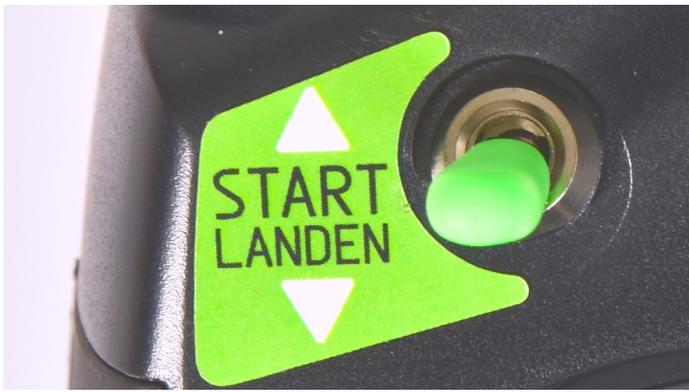
Die automatische Landung kann jederzeit Umschalten des grünen Schalters auf **LANDEN** ausgelöst werden. Der Flight Trainer übernimmt die Kontrolle und fliegt den Heli aus jeder Position im Raum autonom zurück über die Plattform, und landet dort.
