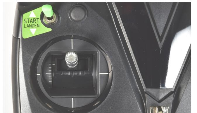
Ziehen Sie den Pitchknüppel komplett nach hinten, schieben Sie ihn nach vorn, um die Kontrolle zu übernehmen. Der Sender bestätigt mit einer Tonfolge.
