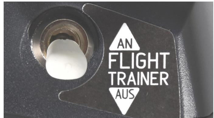
**Gefahr** Es ist notwendig, das System vor unbeabsichtigtem Anlaufen zu schützen. Der Schalter **MOTOR** muss bei Nicht-Betrieb stets auf **AUS** stehen, der Heli wird sonst beim Umschalten auf **START** erneut anlaufen, der Heli wird sonst auch beim Umschalten auf **FLIGHT TRAINER AUS** anlaufen.
