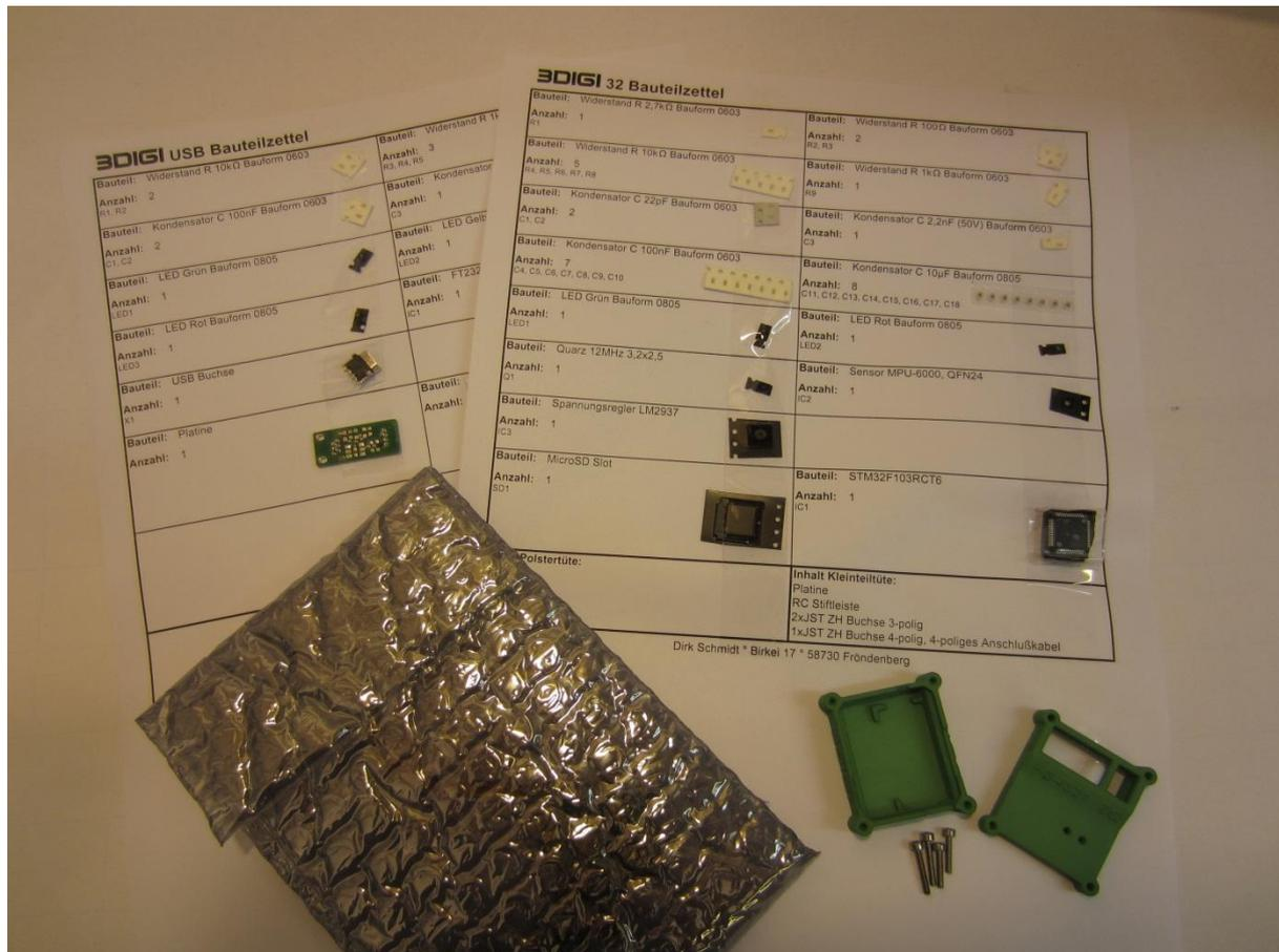
Die Bauteile werden teilweise in kleinen, beschrifteten Tüten oder, wie oben zu sehen, einzeln auf ein Blatt Papier geklebt, geliefert. Manche der Bauteile (z.B. Kondensatoren) sind nicht selbst beschriftet und können nicht unterschieden werden. Daher sollten diese erst unmittelbar vor dem Einlöten aus der Verpackung oder vom Blatt genommen werden.
